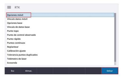
En este menú indicaremos el nombre del tipo de levantamiento, el formato de correcciones que queremos utilizar, el tipo de receptor con el que estamos trabajando y su altura de antena.
